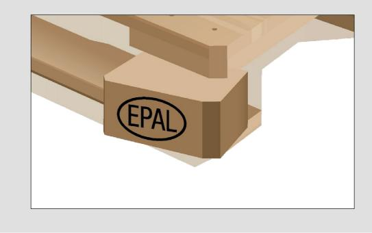
Die EPAL-Kennzeichnung fehlt auf beiden Eckklötzen einer Längsseite.
